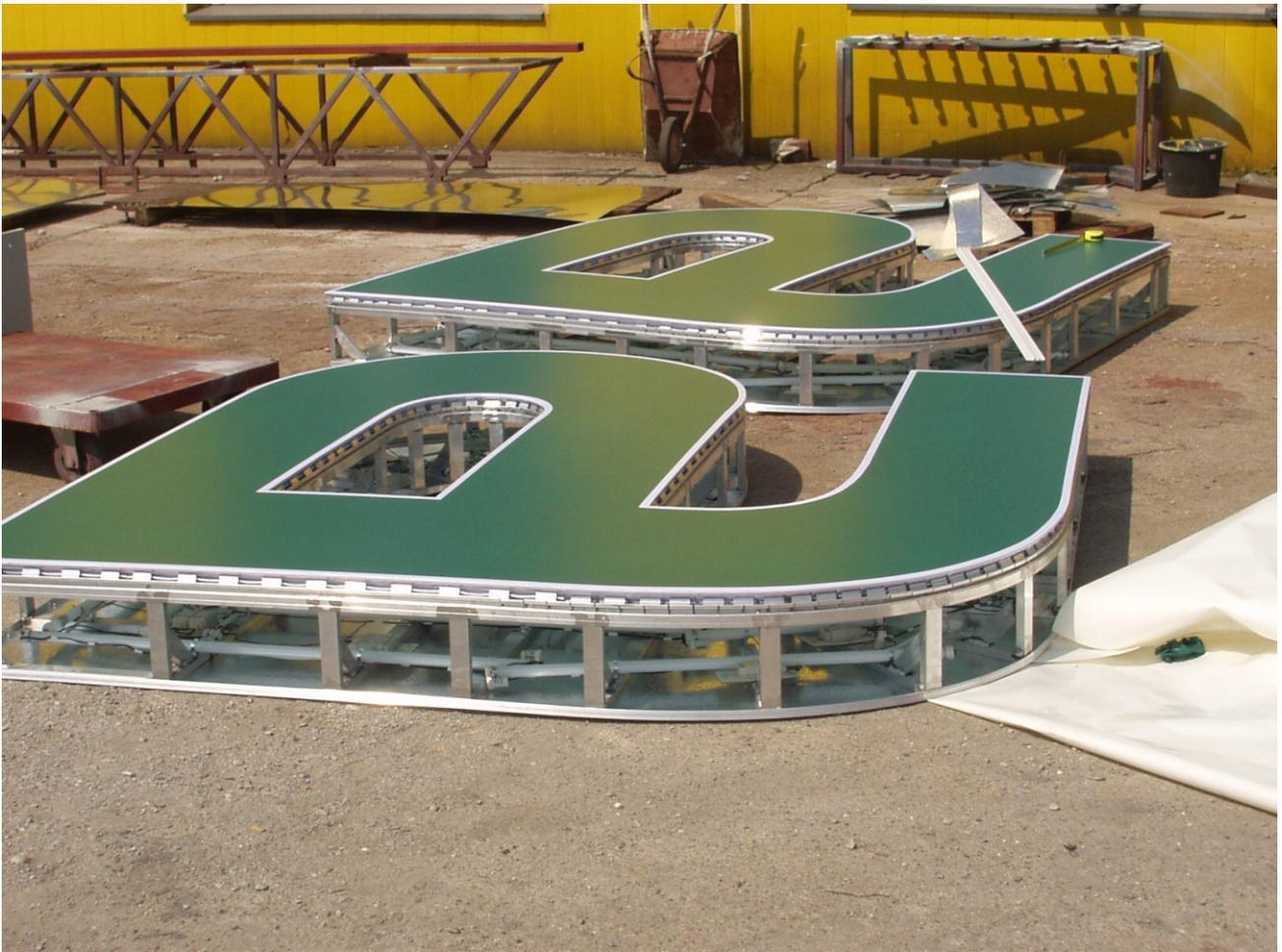
**Abb 7: Buchstaben mit Zarge und Spanntuch ohne seitlichen Abschluss**
