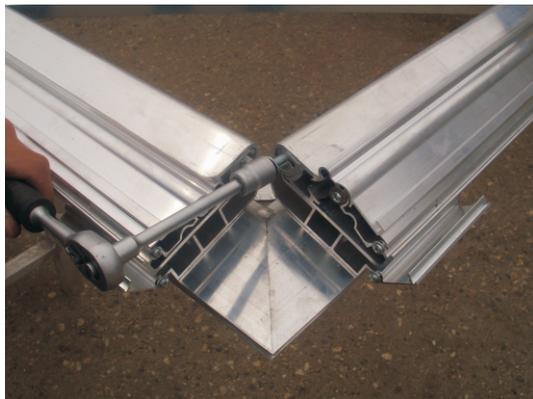
Sichern des Spanmoduls mittels Schrauben vor einem Herausschieben.
