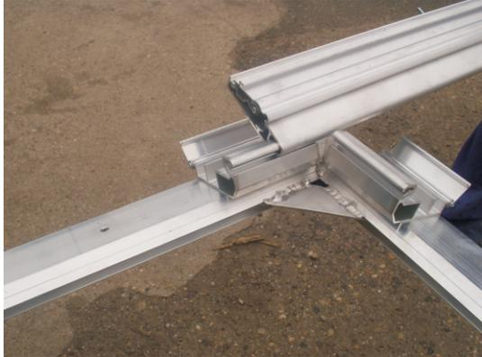
Einschieben des Spanmoduls in das Grundprofil.
