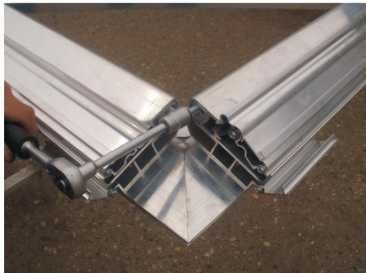
Sichern des Spannmoduls mittels Schrauben vor einem Herausschieben.
