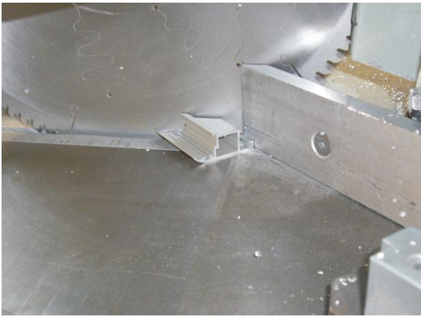
Zuschnitt der an das Scharnierprofil anschließenden Fensterprofile - PCO 1054 (bei seitlich öffnendem Schaukasten: oberes und unteres Fensterprofil)
